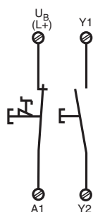
Fig. 5: Circuito de entrada monocanal: conexionado de PARADA DE EMERGENCIA, rearme manual/Circuito di ingresso monocanale: circuito di arresto di emergenza; start manuale/Eenkanalig ingangscircuit: Noodstopschakeling; handmatige start
