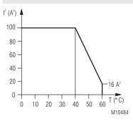
Max. zulässiger Strom bei  $60^{\circ}$ C über 4 Kontaktreihen =  $2A \triangleq 4x2^{2}A^{2} = 16A^{2}$
